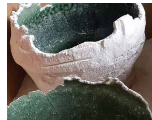
Schmelzergebnis: Versuch 7 u. 8, Glastigel, Durchmesser ca. 27 cm
