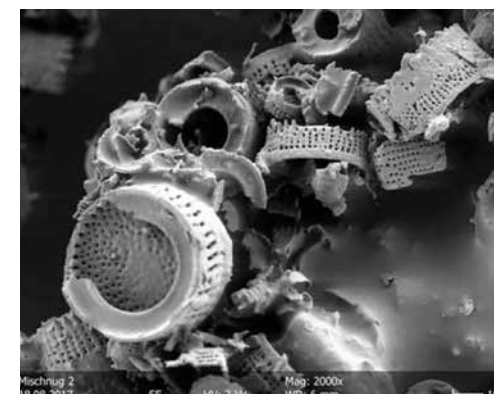
Diatomeen Schalen im Elektronenmikroskop (2000-fach)
